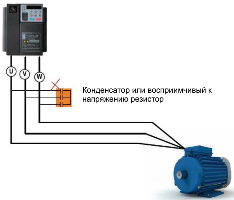
Рис. 1-2. Недопустимые подключения к выходу привода переменного тока
