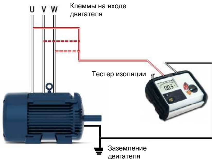
Рис. 1-1. Соединения, требуемые для проверки изоляции двигателя.
